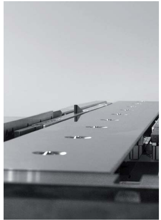
Pneumatisch absenkbarer Winkelanschlag im Gang und Anschlagfinger positionieren das Blech mit höchster Genauigkeit.
