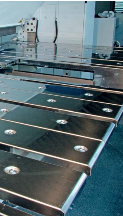
U-Anschlag mit Kugelrollen im Tisch zur leichteren Blechführung
