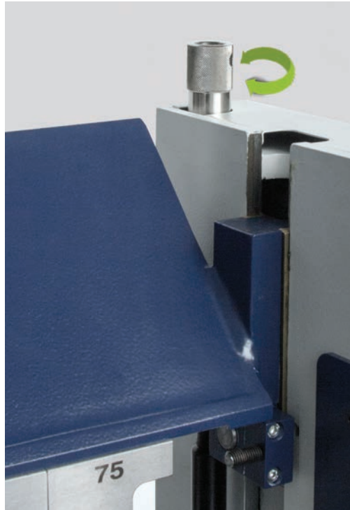
Klemmdruckeinstellung der Oberwange
