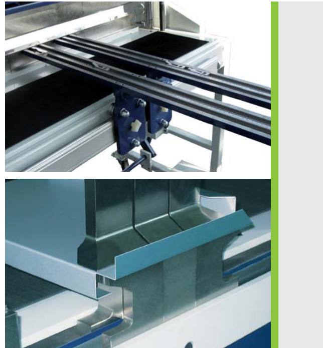
Variable Anschläge sorgen für Präzision (Bild oben). Eröffnen Möglichkeiten: Segmentierte Werkzeuge an allen drei Wangen (Bild unten)
