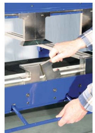
Patentierte Exzenter-Schnellklemmung für Ober- und Biegewange
