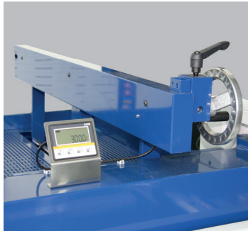
Manueller Hinteranschlag, von vorne verstellbar, mit Digitalanzeige
