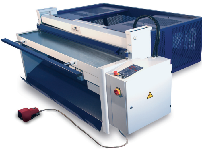
MHSU mit POS 100 Steuerung und Blechhochhaltevorrichtung nach vorne
