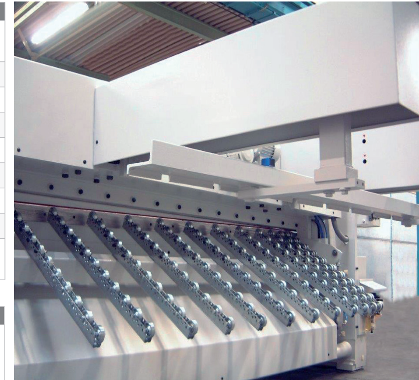
Blechhochhaltevorrichtung pneumatisch gesteuert mit Rollenleisten
