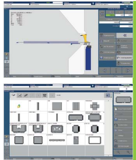
Oben: Standardbiegeprogramme stehen in der Produktauswahl zur Verfügung. Unten: Die Software zeigt die Bearbeitungsschritte vorab.
