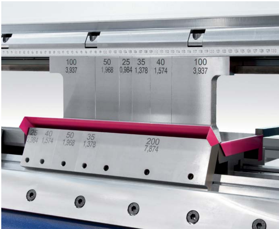
Manuelle Werkzeugklemmung: Segmentierte Werkzeuge an allen Wangen eröffnen Freiräume.
