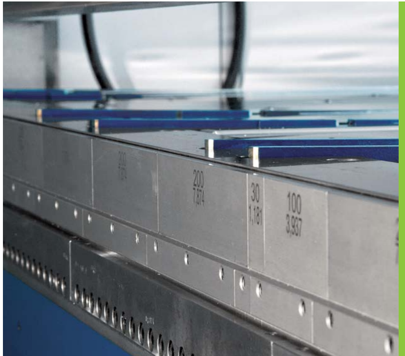
Segmentierte Werkzeuge an der Biegewange eröffnen Freiräume.
