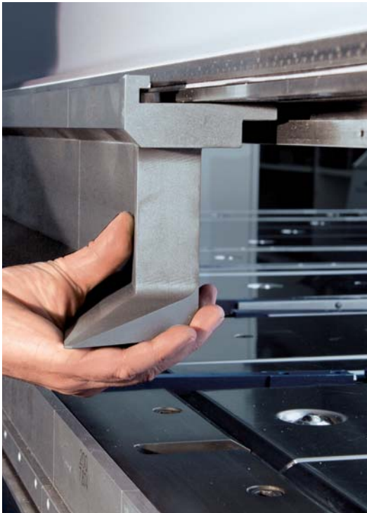
Die optionale hydraulische Werkzeugklemmung verkürzt Rüstzeiten.
