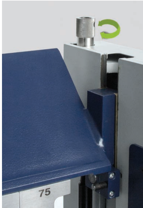
Klemmdruckeinstellung der Oberwange
