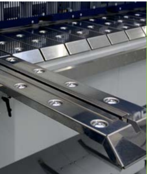
Verschiebbare Tischverlängerung auf Führungsschiene montiert
