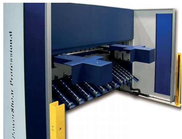
Rückansicht: Motorischer Hinteranschlag und Blechochhaltevorrichtung sowie Rückraumabsicherung
