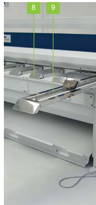
Tischaufbau mit auswechselbaren Edelstahl-Auflageblechen mit Griffmulden [8] und rechter verlängerter Winkelanschlag mit Maßstab incl. seitlichem Klappanschlag auf Linearführung [9]
