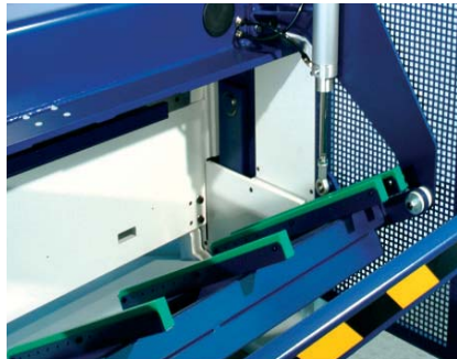
Blechhochhaltevorrichtung nach vorne, pneumatisch gesteuert, incl. Blechrutsche 750 mm bzw. 1000 mm
