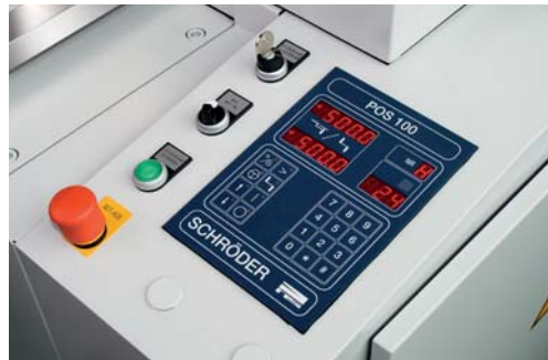
NC-Positionieranschlag POS 100 mit 9-fach Programm 750 mm oder optional 1000 mm
